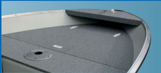
[ME-1329] Bow deck with storage space / Bugabdeckung mit Lagerfach
